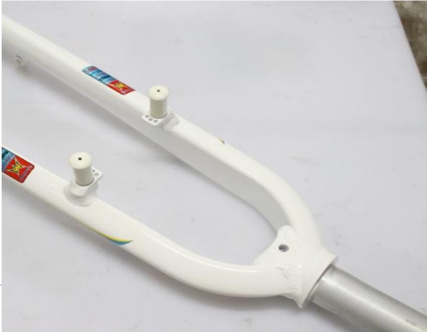
▶ La forcella in una [bici](#) è la parte anteriore del telaio che accoglie la ruota anteriore e lo sterzo
